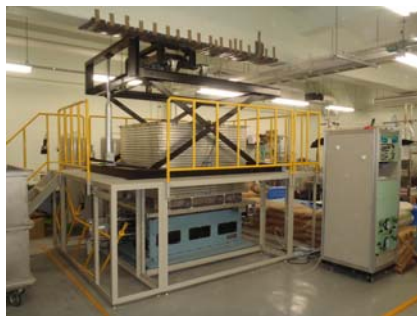
Fig.1 振動台実験装置
