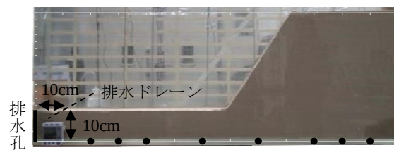
図 2 基礎地盤と堤体の実験の初期状態 (Case_2)
