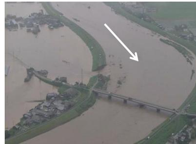
図 2 九州豪雨による矢部川破堤 (2012.7)
