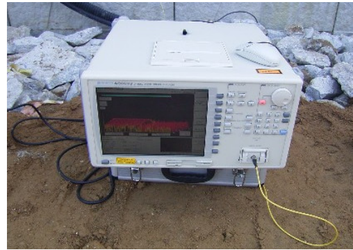
写真-1 BOTDR 計測器によるひずみの計測状況
