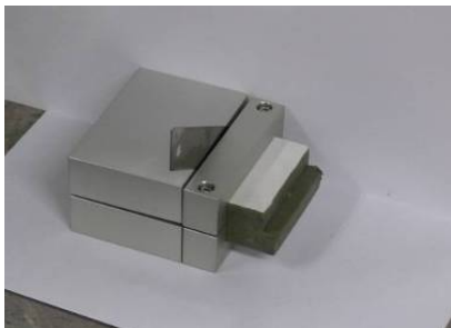
写真-8 専用器具による供試体の切断
