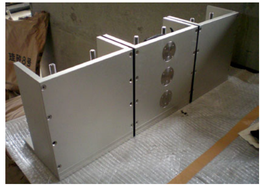
写真 - 1 擁壁模型の外観
