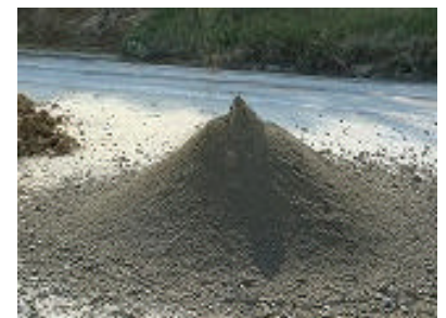
図 2 建設汚泥改良土
