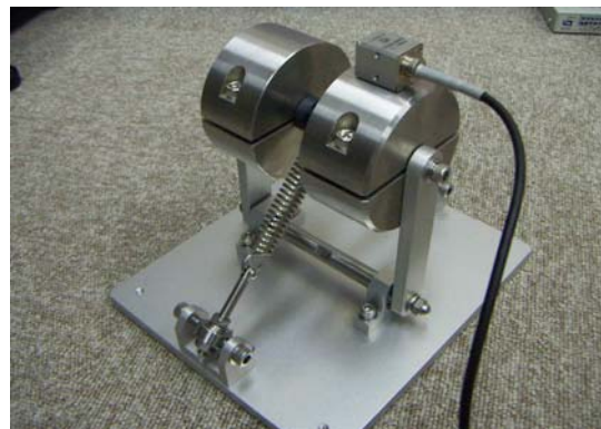
写真 - 1 振動 - 滑動物理モデルの外観
