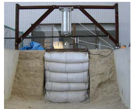
図-13 模型盛土荷重実験システム
