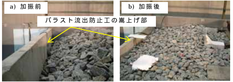
写真1 CASE3の加振前後のバラスト肩の状態
