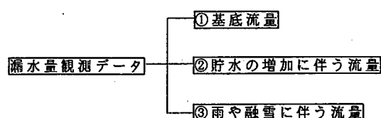
図-1 漏水量の分類
