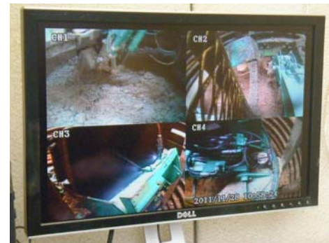
図-4 掘削用モニター
