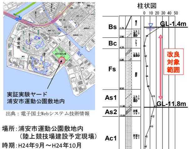
図-9 実証実験位置図および柱状図
