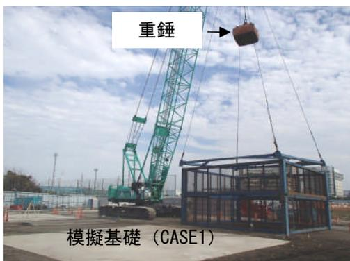
写真-5 動的載荷試験状況
