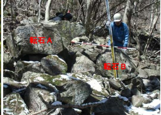
図-10 斜面の現地の状況 (大小礫が堆積している)
