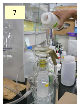
ろ液の pH、EC、 溶出濃度等 を測定
