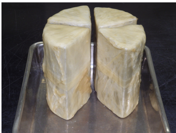
写真-6 パラフィン施工状況
