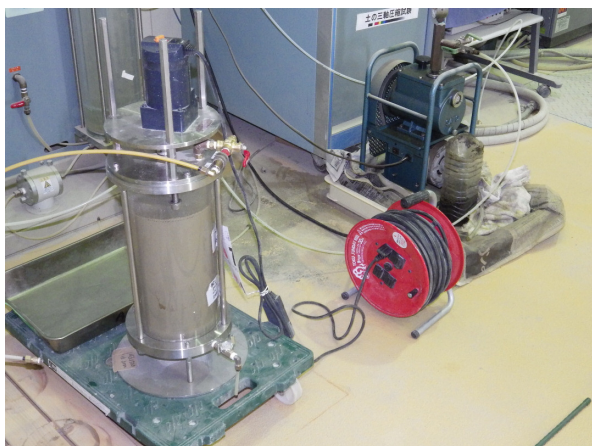
写真-1 攪拌・脱気状況
