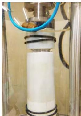
図 7 100 回繰り返した時の供試体の様子
