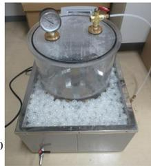
図2 脱気水槽と恒温槽
