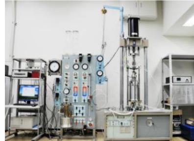
図3 高温中容量三軸試験機
