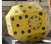
図 5 実規模土堤実験に用いた重錘
