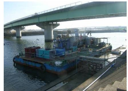
写真-2 台船上に搭載した SJMM-Dy プラント全景
