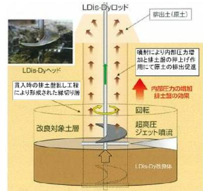
図-3 LDis-Dy 工法の改良機構
