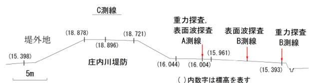
図 2 堤防横断方向における重力探査及び表面波探査測線配置図
