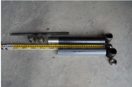
図4 2重管サンプラー
