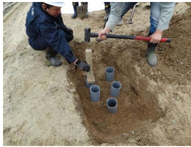
図2 塩ビ管の打ち込み(方法A)
