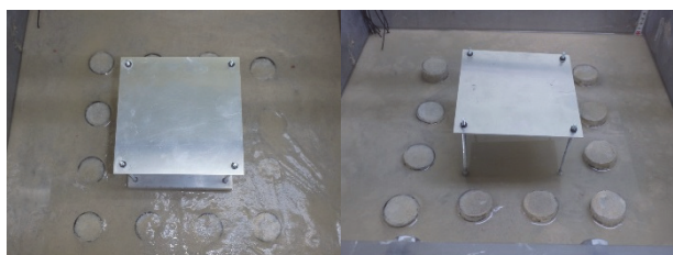
(a) 加振前 (b) 加振後 図16 実験状況 (Case A3: 低改良型柱状改良)
