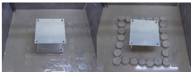
(a) 加振前 (b) 加振後 図15 実験状況 (Case A2: 接円型柱状改良)
