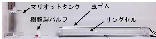
写真-4 MRI 用水平浸透試験装置概観
