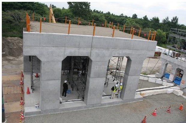
図1 実規模 RC 製ロックシェッドと敷砂緩衝材
