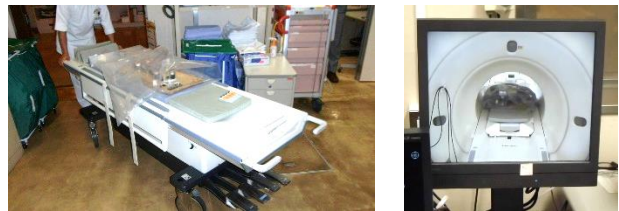
(a) 診療ベッドへの設置状況 (b) 撮影時 写真-5 MRI による水平浸透可視化実験の概況
