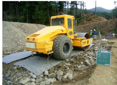
写真 4-4 遮水シート破断実験
