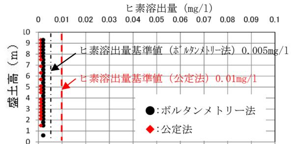
図 5-5 盛土のヒ素溶出量確認試験結果
