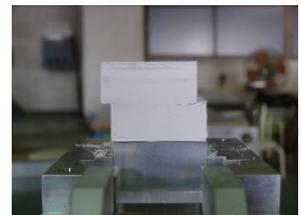
(d) せん断箱から取り外した試験後の供試体
