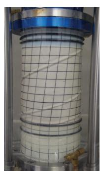
写真2 供試体の様子(薄肉、高さ15cm)
