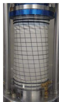
写真1 供試体の様子(薄肉、高さ20cm)
