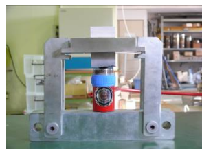
(c) 油圧ジャッキによる下部せん断箱の取り外し
