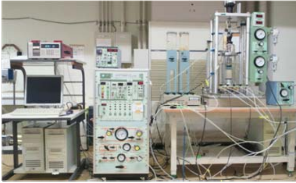
Photo1 動的三軸試験機の概観
