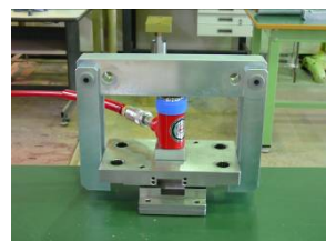
(a) 油圧ジャッキによる上部せん断箱の取り外し
