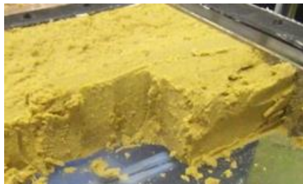
写真-25 確認実験3の土槽内残留油
