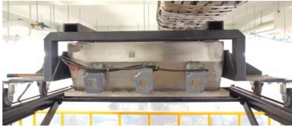
Fig.2.3 油圧リフト装置付振動降砂装置
