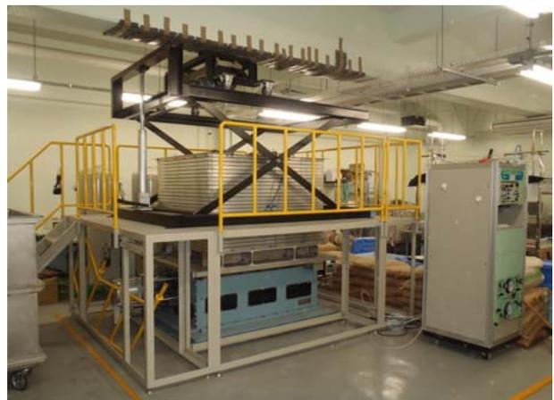
Fig.2.1 1G 場振動台実験装置
