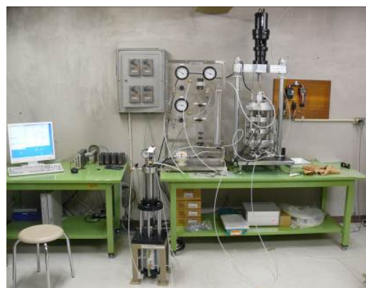
写真 3 高圧三軸試験装置の全景
