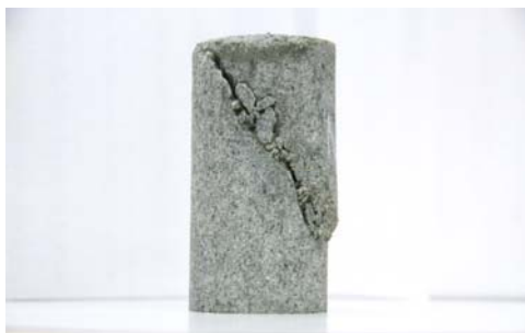
図3-3 試験後の破壊した試料の様子
