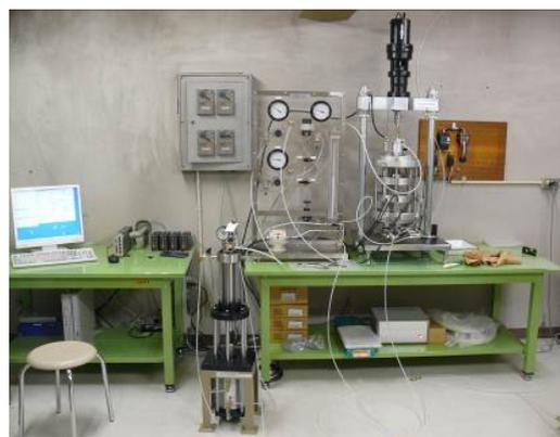
写真 3 高圧三軸試験装置の全景
