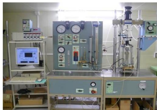
写真 1 三軸試験装置の全景
