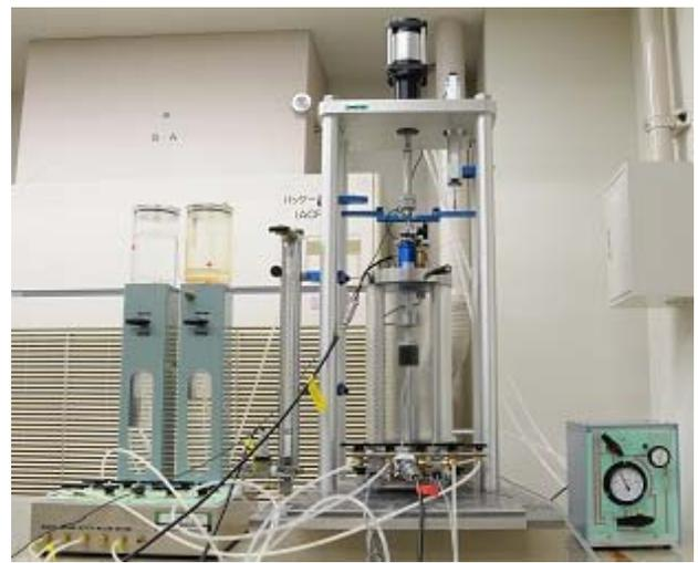
写真1 三軸繰返し載荷装置
