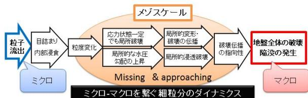
図1 陥没孔発生に至るプロセスとマルチスケールな視点
