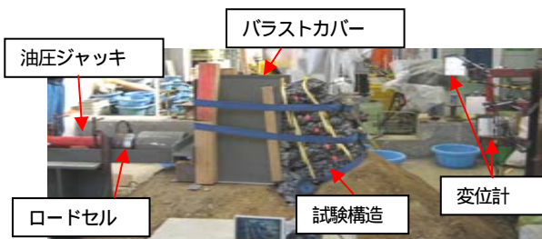
図 - 13 水平支持力試験の試験状況
