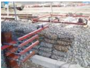
図 - 18 道床横抵抗力試験状況
