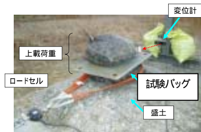
図 - 7 摩擦抵抗力試験の試験状況
