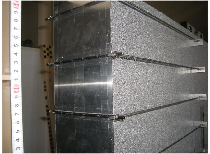
写真2 壁面パネルとタイバー接合部の状態
