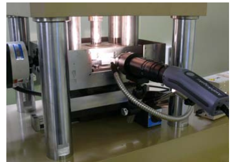
写真-4 マイクロスコープを用いたせん断帯観察システム
