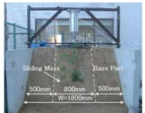
図-11 斜面崩壊実験システム(正面図)
