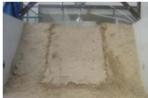
図-15 無補強斜面の崩壊状況
