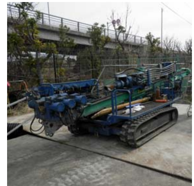
写真-1 専用削孔機全景
