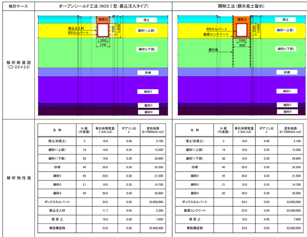
図-4 Case-1 (砂質土地盤) での解析図および解析物性値
