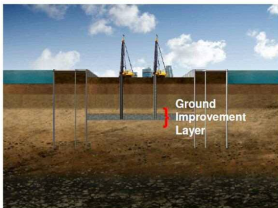
③深層混合処理工法による地盤改良
