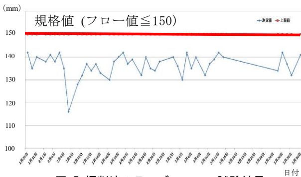
図-5 掘削液のテーブルフロー試験結果
