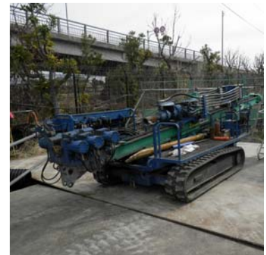
写真-1 専用削孔機全景
