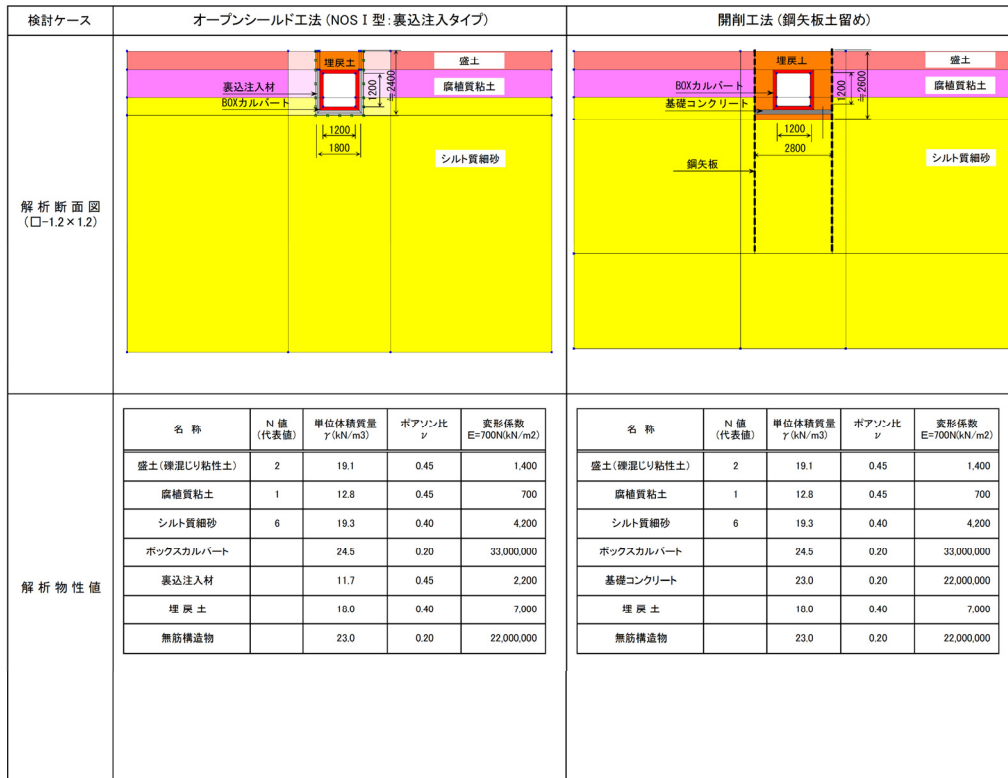
図-5 Case-2 (粘性土地盤) での解析図および解析物性値
