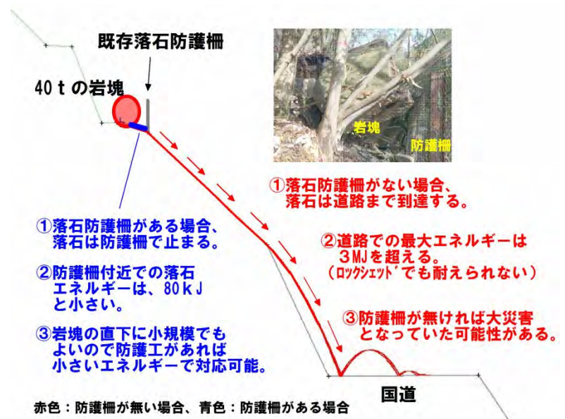
図-15 落石防護柵がある場合とない場合の施設効果検証結果
