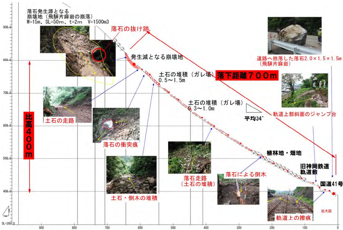
図-2 船津地区の落石経路 (断面図)
