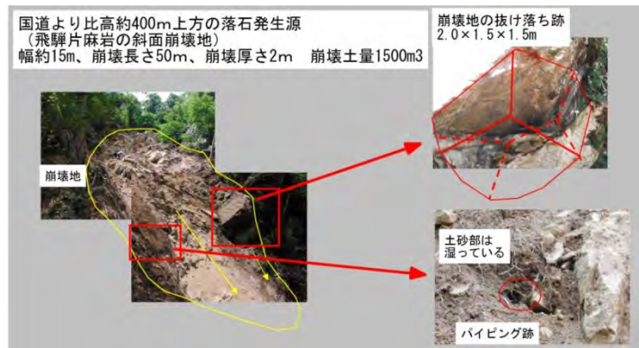
図-5 船津地区の落石原因の推定
