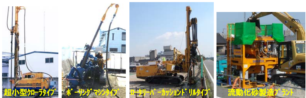
写真-2 施工設備
