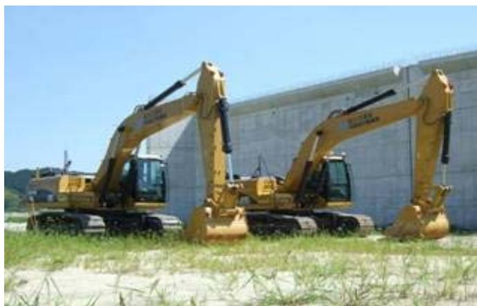
遠隔操縦式分解型バックホウ
