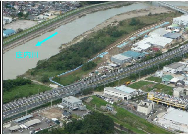
■ 1t土のう積み 延長約480m L=約640個設置
