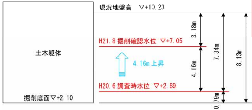
図-6 地下水位の変動
