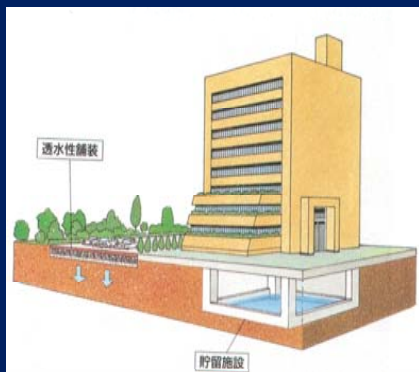
地下貯留施設 透水性舗装
