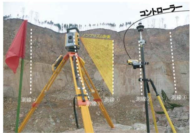
写真-3 ノンプリ計測と測線配置
