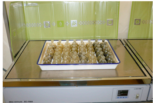
図-4 ホットプレートによる煮沸状況
