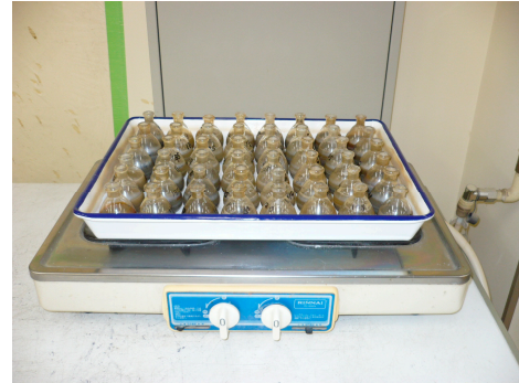
図-3 湯せんによる煮沸の試験状況
